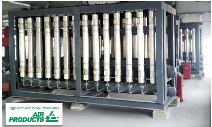
新疆天业乙二醇设备的PB6050型 系统撬装设备
