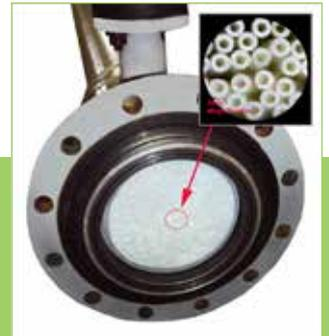
一个普里森膜分离器内有做成束状的成千上万根纤维丝，一端用环氧树脂封固。将束状纤维丝装入一个标准压力容器内使气体在膜分离器内有正确的流向分配和压力分离。
